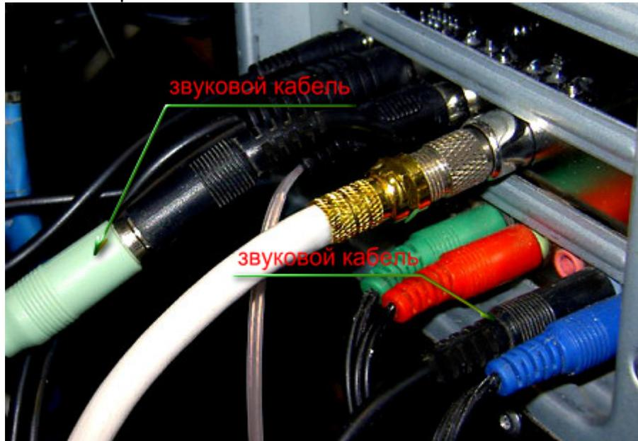
Для соединения антенны и ТВ-тюнера используйте качественный коаксиальный кабель, это поможет значительно уменьшить шумы при приеме сигнала.
