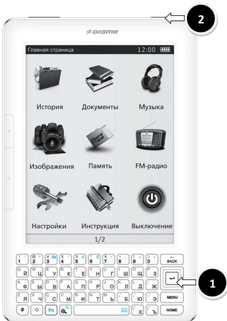
Дождитесь пока мигнет экран. Спустя 1-2 секунды отпустите кнопку питания (2), затем спустя 2-3 секунды отпустите кнопку Ввод (1). Дождитесь обновления прошивки.
