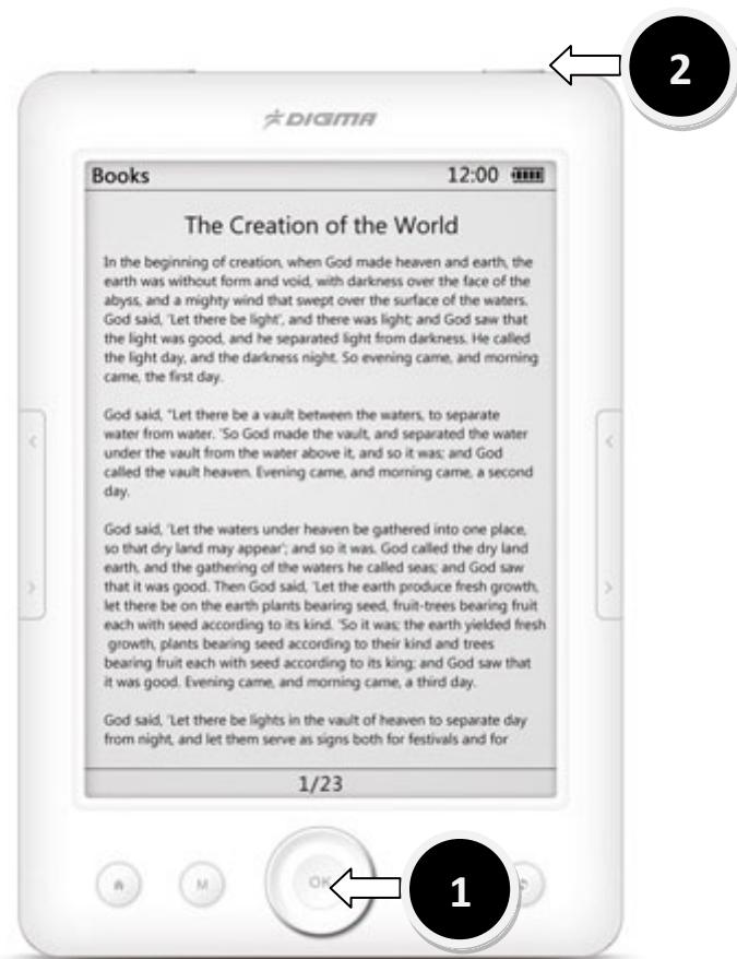
Дождитесь пока мигнет экран. Спустя 1-2 секунды отпустите кнопку питания (2), затем спустя 2-3 секунды отпустите кнопку Ввод (1). Дождитесь обновления прошивки.
