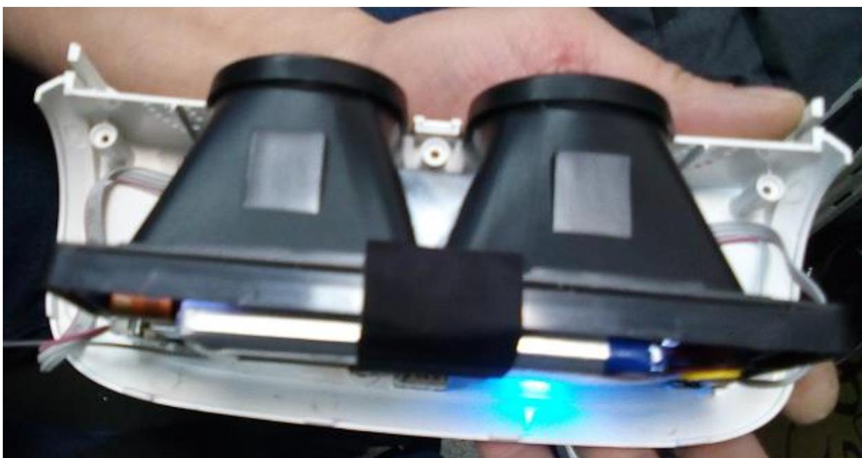
Приподнять системную плату. Под USB разъемом находится саморез.
