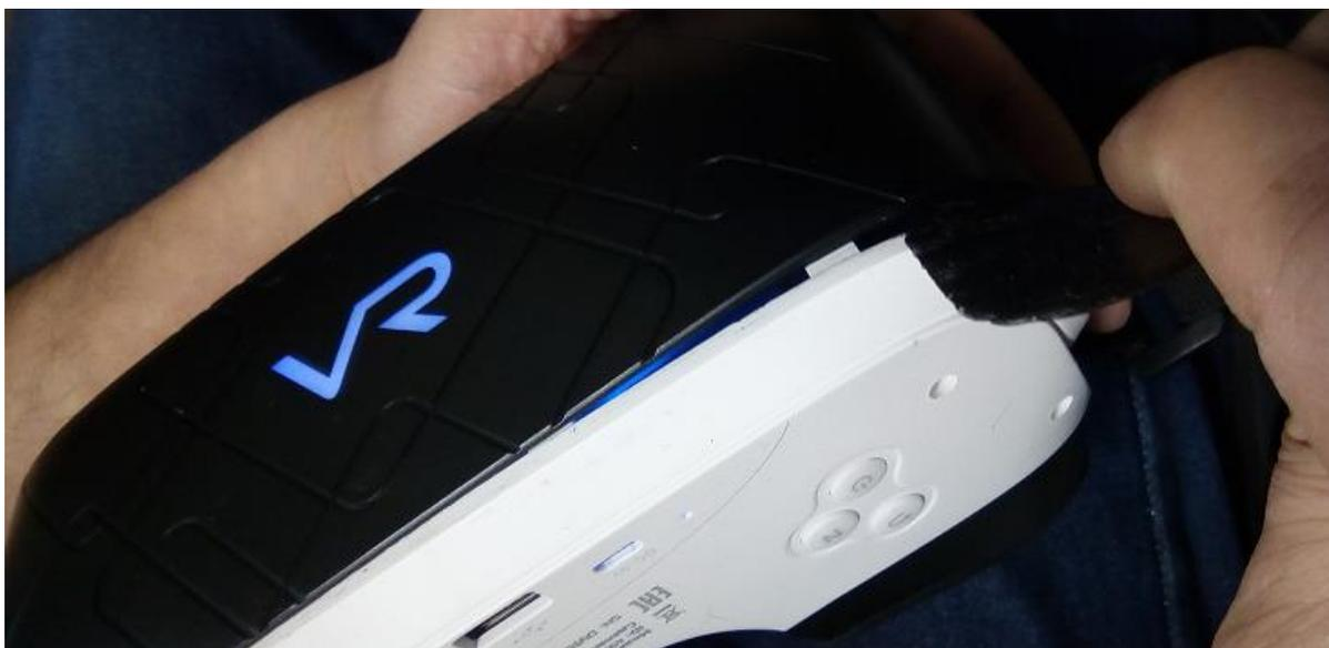
Отсоединить мягкую амбушюр по всему периметру корпуса. Под ней спрятаны винты крепления.
