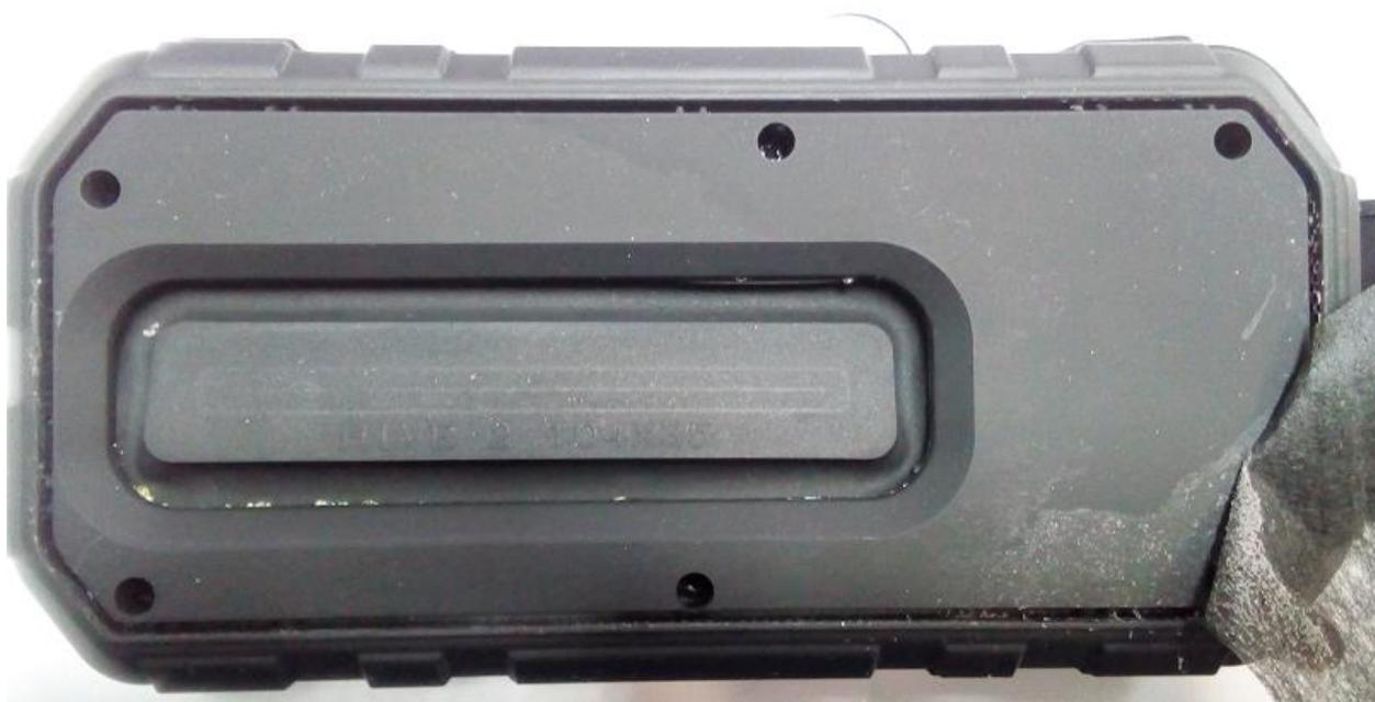
Приподнять резиновую боковую облицовку –бампер. До конца снимать ее не нужно, достаточно извлечь из пазов.
