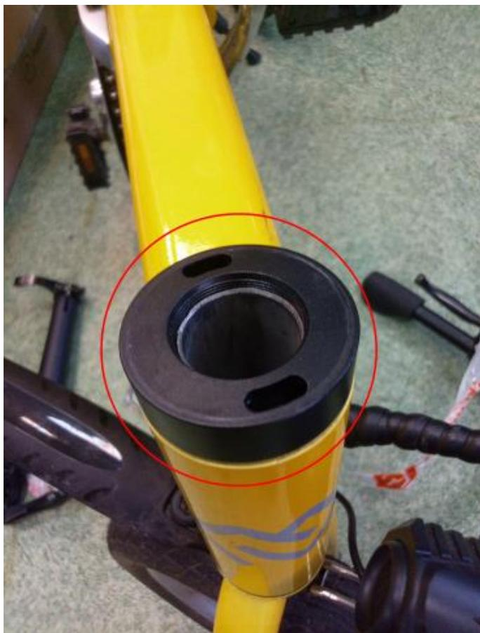
4. Затянуть гайку до устранения люфта
