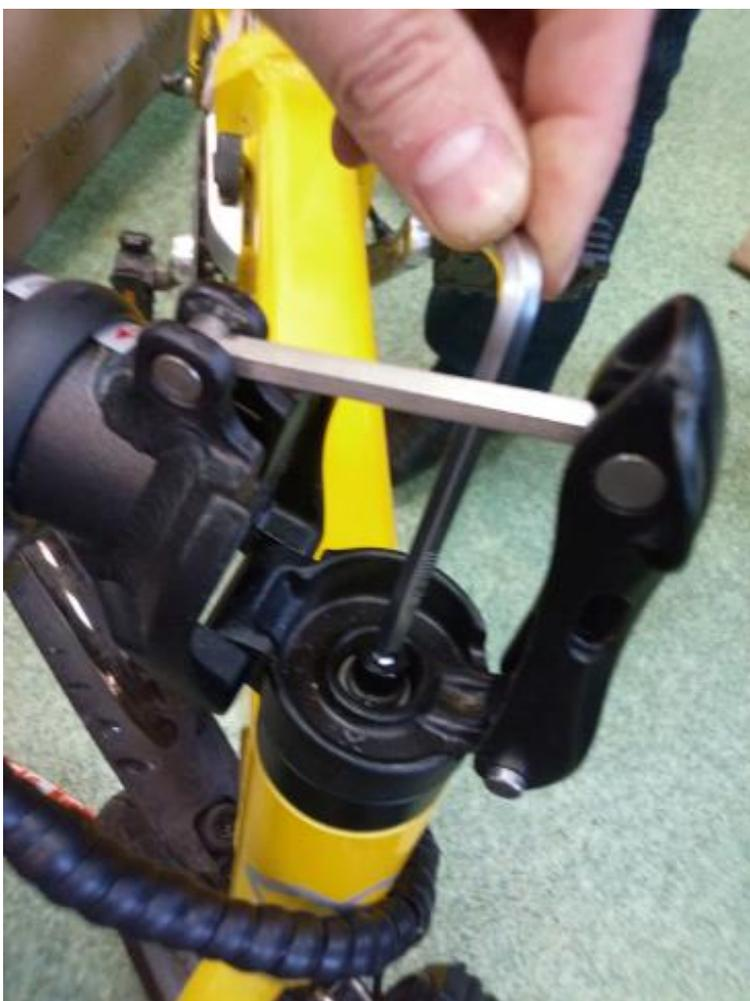
2. Снять рулевую стойку
